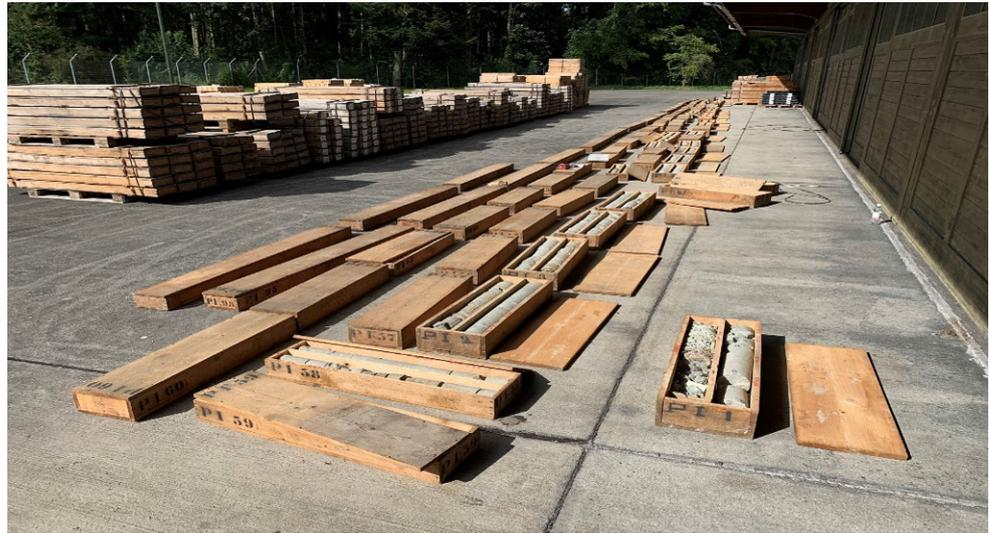
Abb. 6: Molasse-Aufschluss entlang der FCC-Trasse. Proben wurden aus dem Gesteinsverband entnommen und als vollständige Kerne oder als Plugs (kleine, zylinderförmige Proben) im Labor analysiert
